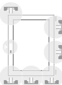
клас протизламності RC2 / Klasse „Einbruchssicher“ RC2
